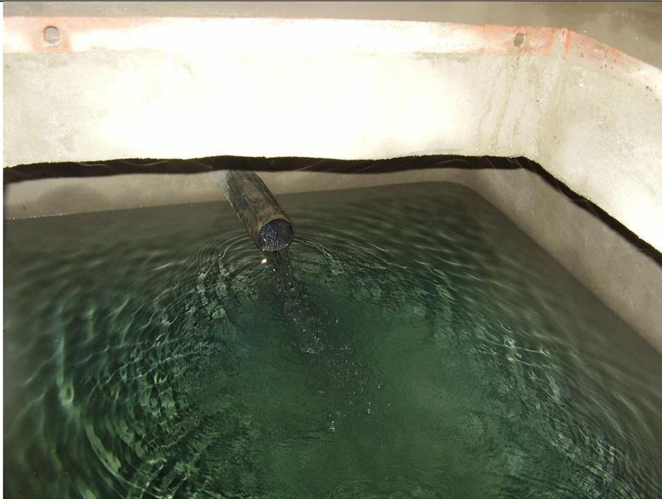
Test impermeabilità delle vasche di trattamento
