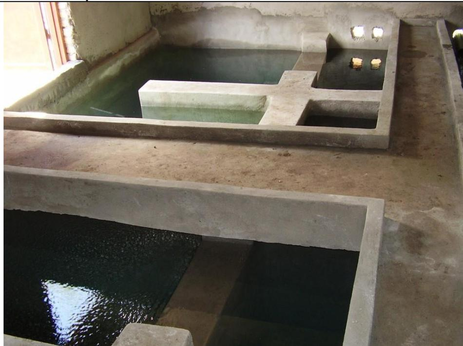
Test impermeabilità delle vasche di trattamento
