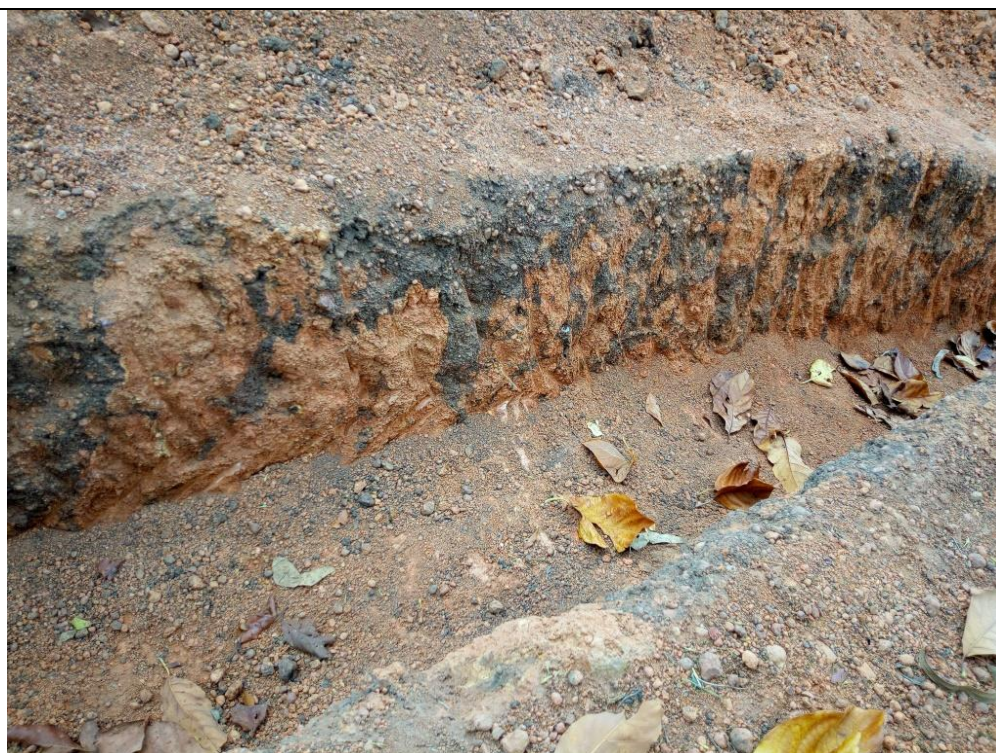
Particolare della laterite durissima da scavare
